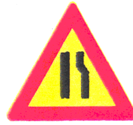
(K - 6β) Επικίνδυνη στένωση οδοστρώματος στην δεξιά πλευρά.
