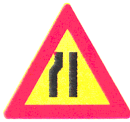
(K - 6α) Επικίνδυνη στένωση οδοστρώματος στην αριστερή πλευρά.
